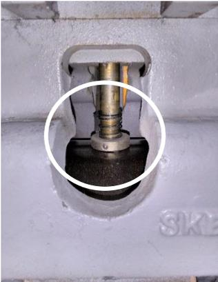
⑫ プライヤー等を使用して、バネ端部を加えて鉄芯ロッドを回転(右回転又は左回転)させながらバネを外して下さい。
