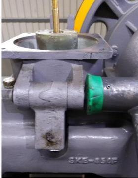
c: ピンを抜くとブレーキ開閉レバーが取外せます。
