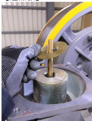
⑩反メインシープ側のブレーキ開閉レバーを外して下さい。
