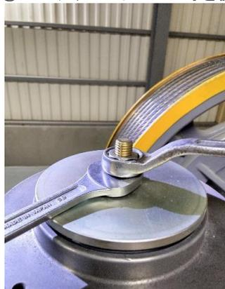
⑥1個目のナットを外し2個目のナットを外すときは鉄芯当て板側面部の六角穴付止めネジくぼみ先に六角レンチを取付け固定して、スパナ等で2個目のナットを緩め外して下さい。
