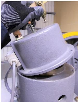
④コイルケースカバー側面部の端子BOXのナベネジ4本をプラスドライバー緩めて結線を外して下さい。
