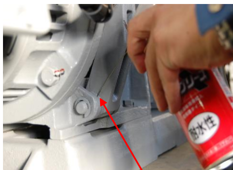
写真 1 : ブレーキアームピン部
