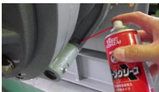
【写真3-6-①】ブレーキアームピン部
