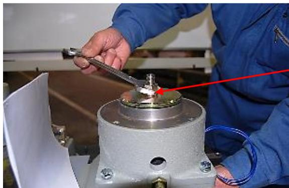
⑧ 六角レンチで固定し、2個目のナットを取外して下さい。
