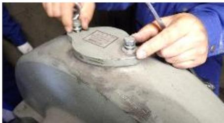
③ 外したボルトにIボルトを付ける。
