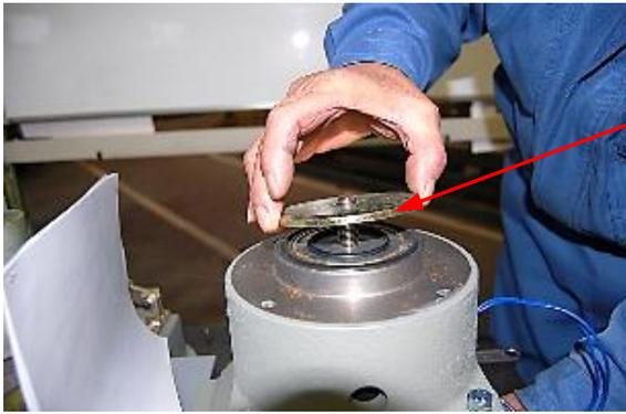
⑨ 可動鉄芯カバープレートを取外して下さい。
