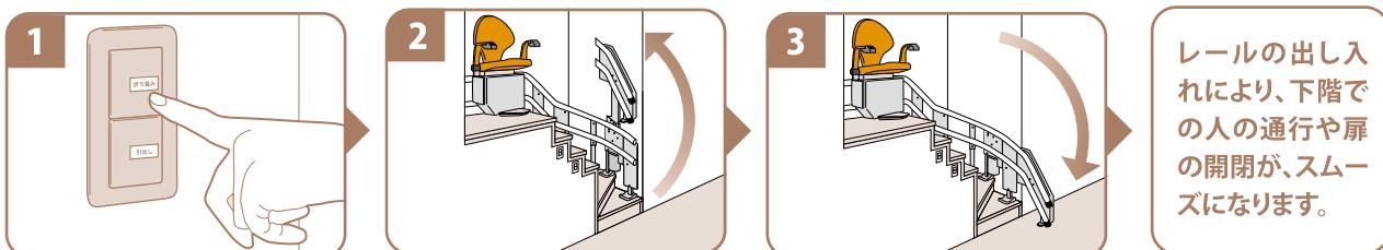
下階にある折り畳みボタンを押し続けます。レールを折り畳む為にいすは自動で待機位置に動きます。
