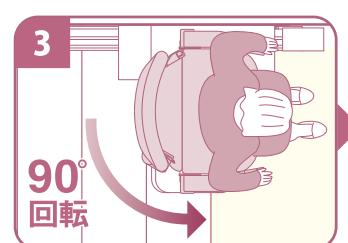
警報が3回鳴りシートが進行方向に90°回転します。停止するまで回転させると、停止音が鳴り停止します。
